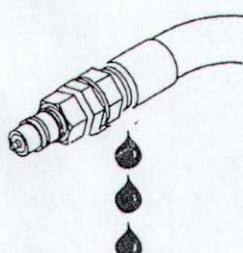
(N) Kontrollér at ingen lekkasje av hydraulikkolje finnes.
