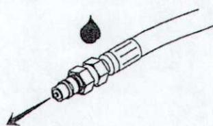
(N) Koble slangen til lasterens 3. funksjon.
